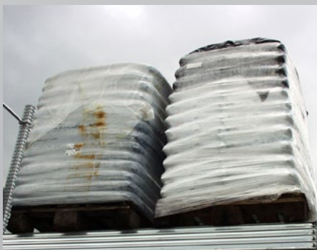
传统缠绕膜包装方式 - 防雨，防尘，防污染能力较差。
