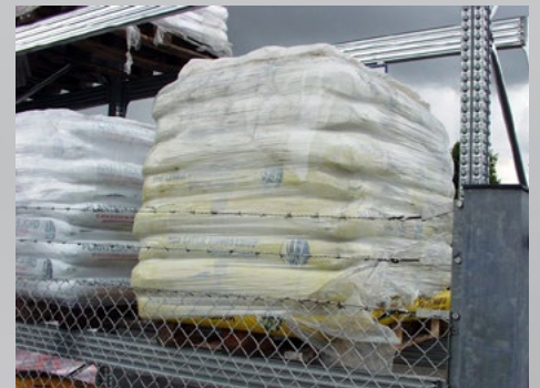
传统缠绕膜包装方式 - 由于包装不严密，容易进水而导致产品损坏。
