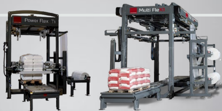
传统缠绕膜包装方式 - 底部包装松散不严实，产品容易暴露于外，受到各种环境的影响。
