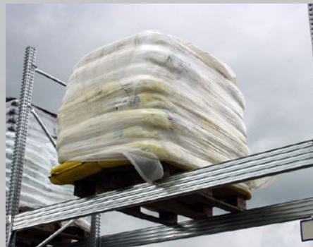
传统缠绕膜包装方式 - 底部包装松散不严实，产品容易暴露于外，受到各种环境的影响。
